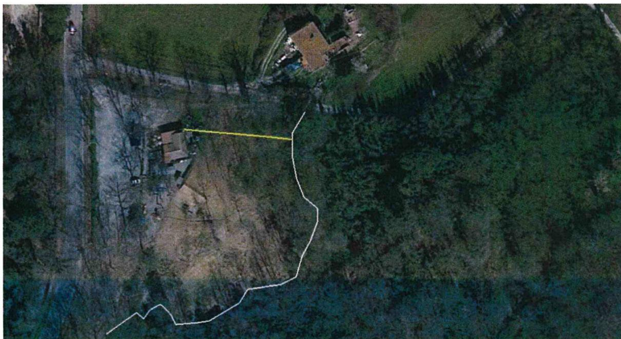
**Figura 9.** *Vista di una linea di misura della distanza dello spigolo dell'edificio dal limite del bosco (circa 43 m)*
